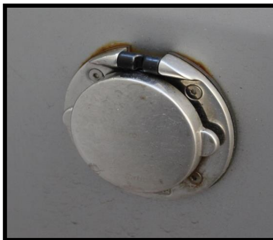
13. attēls. Elektrozlādes pieslēguma ārējā konstrukcija labajā sānā.
